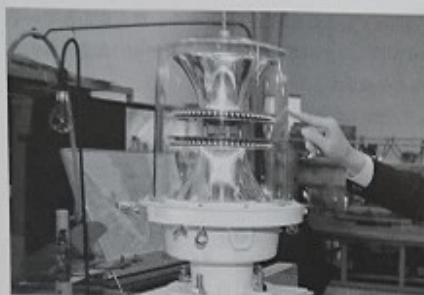
反射鏡を使った初期のLED灯器
