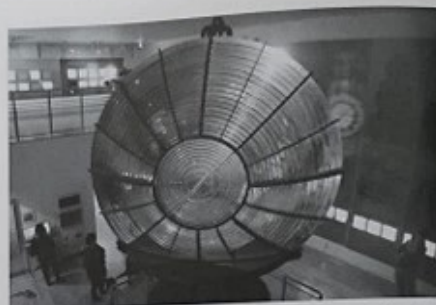
大穴塔に展示されている1等レンズ レンズの直径:3.03m、重量:2.65t
