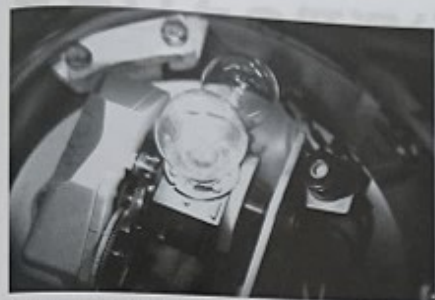
電球を用いていた灯器の内部 予備の電球が見える
