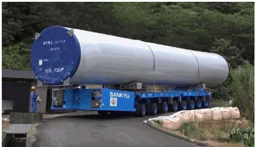
タワーを運ぶ車両
