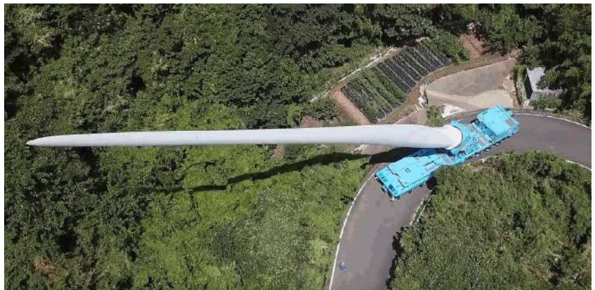
ブレードを運搬する車両（長さ12m・自重36t）
