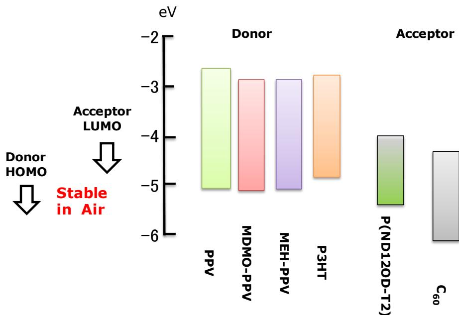
図 導電性高分子の HOMO,LUMO 準位と空気中での安定性
