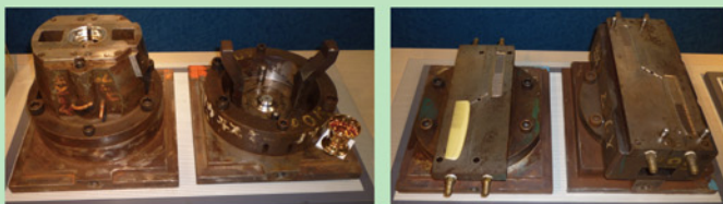
Isoma射出成形機用金型:ウィスキーコップ(左)と樽(右) (積水化学工業(株)京都研究所 蔵)
