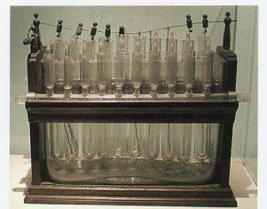
ウルシオールの構造を決める際に真島利行が実際に使用したオゾン発生装置 (所蔵および ©:大阪大学総合学術博物館)
